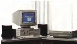
Alcune stazioni di sviluppo Olivetti di soluzioni applicative multimediali. Quelle in basso è costituita da un personal computer M38002 completo di editoria video digitale e di periferiche AV quali un lettore di videocassette ed altoparlanti. Il software è costituito da IMAGE Media Control Library, Autiform tool set Tool con il dell'ambiente operativo grafico Microsoft Windows.
